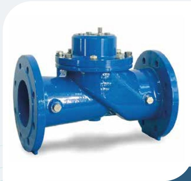
Válvula con operación de pistón, clase PN 40, disponible en la serie 500 con paso reducido y 600 con paso total de DN 50 a DN 200, bridas según EN 1092/2 y otras bajo demanda.
