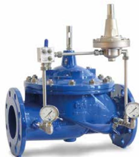
La válvula XLC 370/470, colocada a la base del depósito de agua del cual toma presión para la detección del nivel piezométrico, cuando alcanzará el nivel máximo preestablecido cerrará gradualmente la alimentación, para volver a abrirla cuando este comience a descender otra vez.
