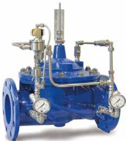
Válvula de control CSA XLC 390/490 actúa como válvula antirretorno y regula la maniobra de arranque y parada bomba previendo el golpe de ariete.
