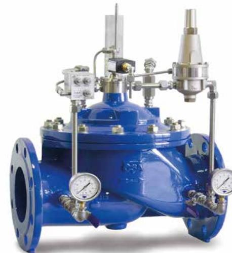
La válvula de control CSA XLC 392/492 actúa como válvula antirretorno y regula la maniobra de arranque y parada de bomba previendo el golpe de ariete. Dispone de un piloto sostenedor para mantener la presión aguas arriba.
