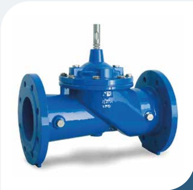
Válvula de globo, tipo diafragma, PN-10-16-25 bar, con paso reducido, fabricada en hierro fundido dúctil con componentes internos en acero inoxidable, disponible desde DN 80 hasta DN 800, bridas según EN 1092/2 y otras bajo demanda.
