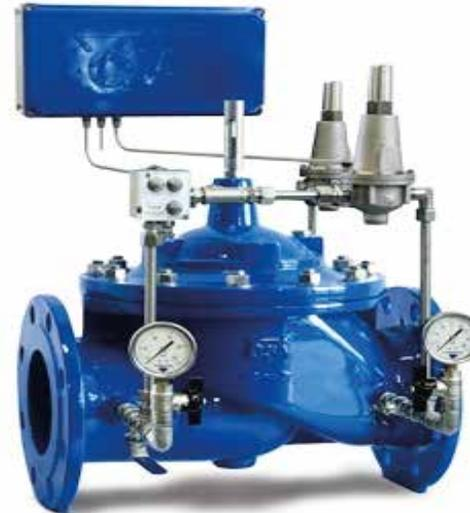
Reductor de presión con dos niveles de presión y programador con bluetooth, con doble piloto reductor que reduce y estabiliza la presión aguas-abajo a dos valores de consigna seleccionables. El programador por batería con comunicación Bluetooth es manejable de forma remota desde una intuitiva app, sin necesidad de acceder a la localización de la válvula.
