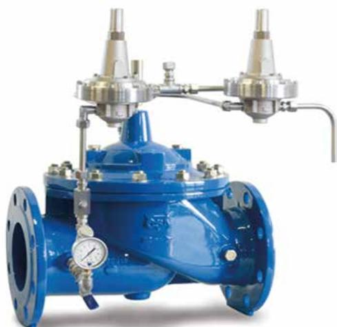
Válvula XLC 370/470-D, colocada a la base del depósito de agua del cual toma presión, regula entre un nivel máximo y mínimo, independientemente de las variaciones de presión aguas arriba.
