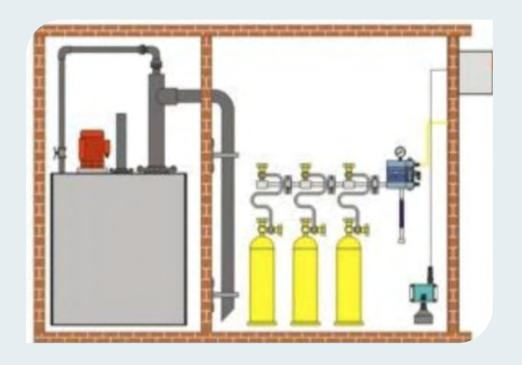
La causa más común de fugas de cloro es negligencia, falta de mantenimiento proventivo, manipulación inadecuada de los cilindros de cloro, empaques de plomo defectuosos o desgastados, válvulas dañadas de los cilindros de gas y manifolds, etc.
